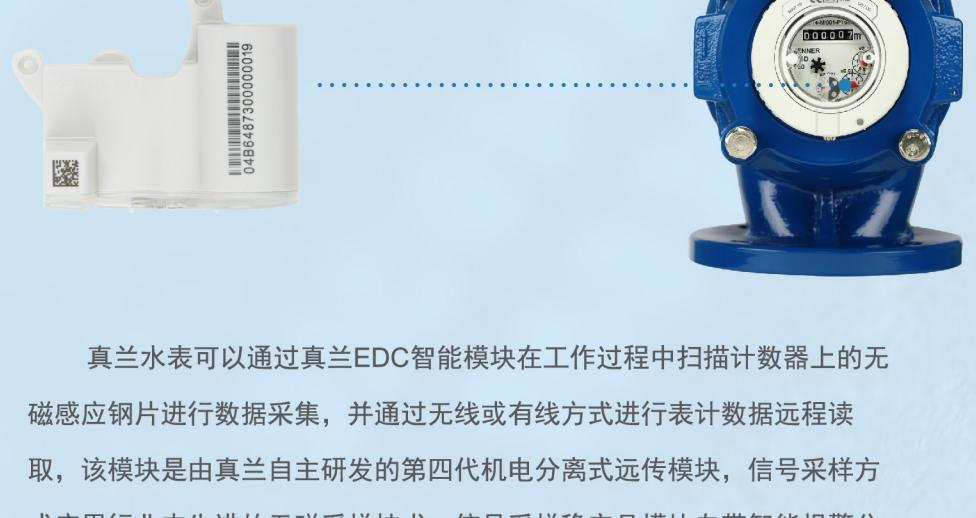
真兰水表可以通过真兰EDC智能模块在工作过程中扫描计数器上的无磁感应钢片进行数据采集，并通过无线或有线方式进行表计数据远程读取，该模块是由真兰自主研发的第四代机电分离式远传模块，信号采样方式应用行业内先进的无磁采样技术，信号采样稳定且模块自带智能报警分析功能，在传输水表读数的同时可以提供各种报警信息。真兰EDC智能模块可以在出厂时安装在水表上，也可以选择现场安装好水表，后期再加装EDC智能模块，实现了表计和模块的机电分离，提供了灵活的安装方案。EDC智能模块适用于真兰DN15~DN300系列水表。
